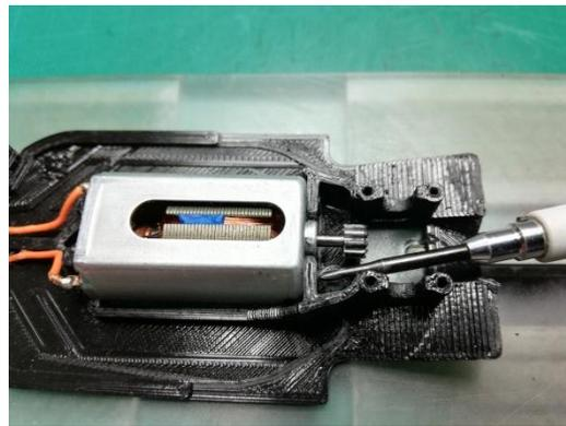
Para el eje trasero elegimos unos cojinetes de labio estrecho por ejemplo los NSR4846, en este caso montamos un motor MB de 22000 rpm piñón de 10 y corona SlotIt de 23.
