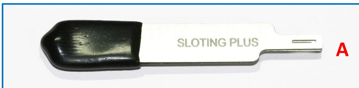
La pinza especial **-A-** se ha desarrollado para sujetar el tornillo de forma cómoda y precisa, y poder colocarlo en cualquier lugar dónde sea muy difícil posicionarlo.
