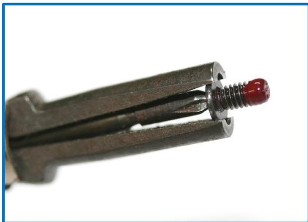
Ponga fijatornillos “blando” o pintura para las uñas en la punta roscada del tornillo tal y como se indica en la fotografía.
