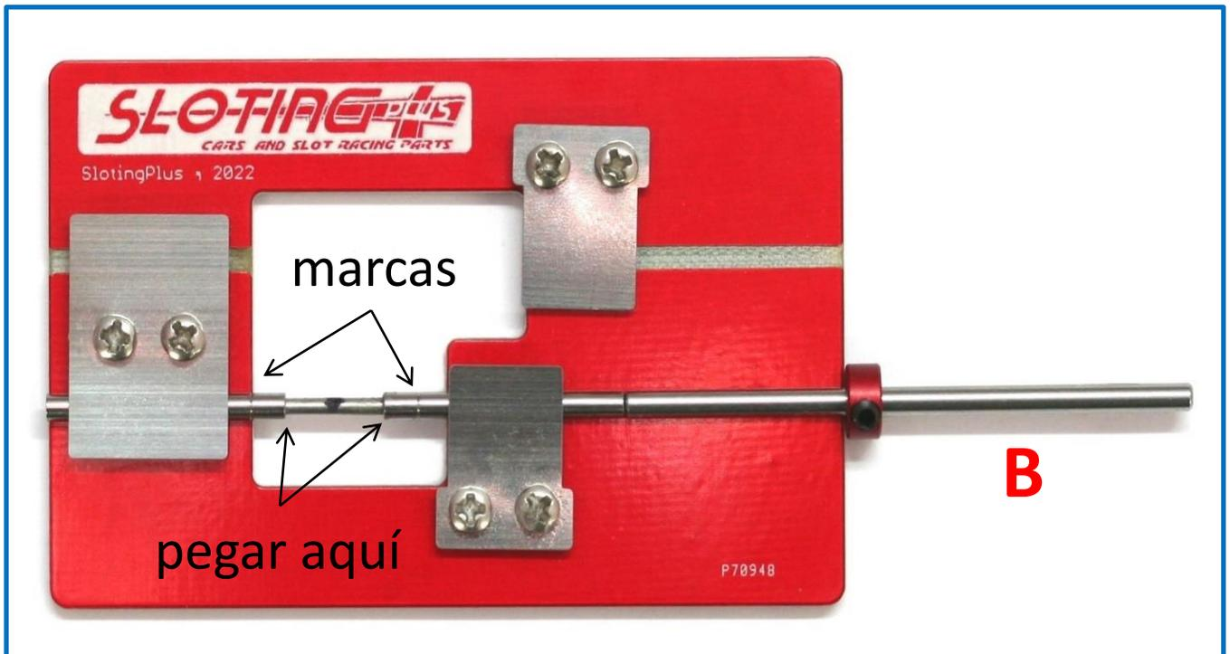
**ATENCIÓN:** Pegue el conjunto con cola tipo Cianoclorato pero usando **-POQUÍSIMA-** cantidad pues el pegamento actuará por capilaridad y es suficiente con muy poca cantidad. Ayúdese de un palillo o similar para depositar el pegamento.
