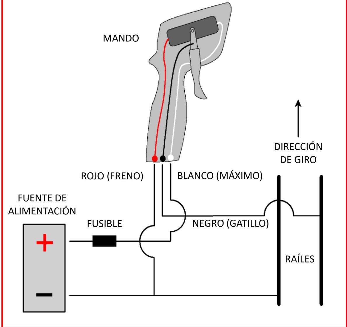
Forma correcta de conectar el mando PRO EVO a la pista y al transformador.
